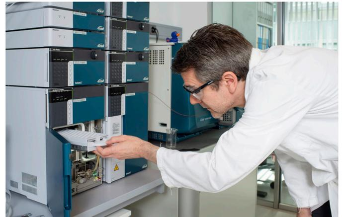
Analyse von Mikroverunreinigungen mittels Flüssigchromatographie-Massenspektrometrie
