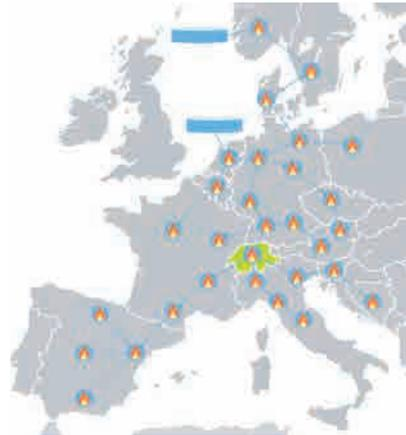
Die Vision «Carbon Hub» verbindet CO<sub>2</sub>-Emissionsquellen über ein kontinentales CO<sub>2</sub>-Netz direkter mit geologischen CO<sub>2</sub>-Speichern.
