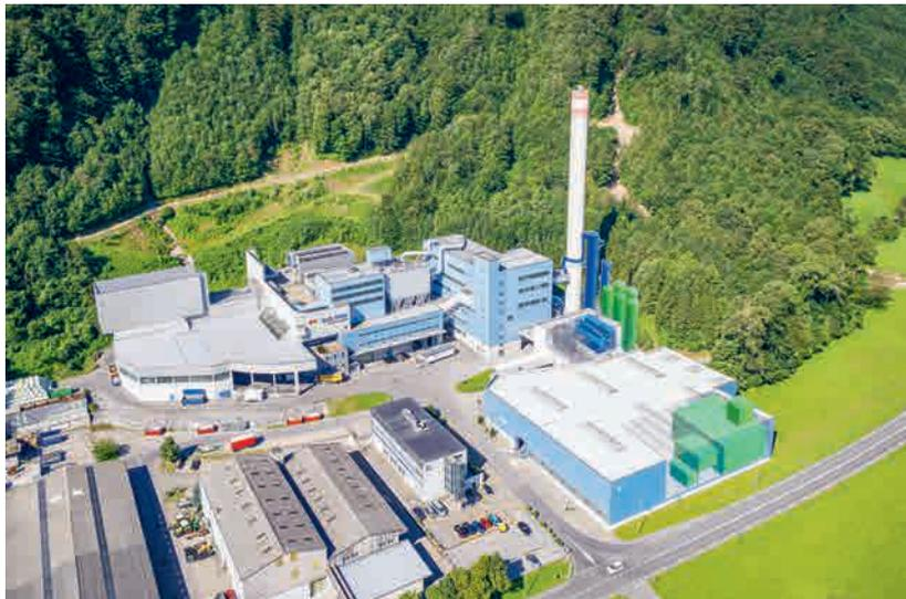
3D-Ansicht der CO<sub>2</sub>-Abscheidung (blau), Zwischenlagerung und CO<sub>2</sub>-Aufbereitung (grün) integriert in die bestehende KVA Linth.
