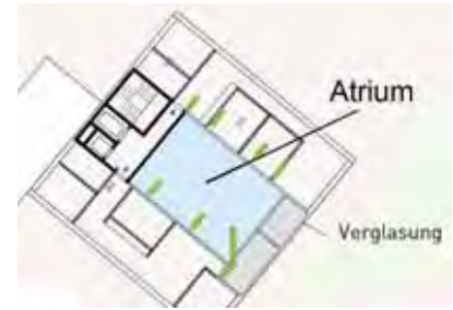
Die Wohnungen in den Hochhäusern sind durch den Autobahnlärm aussen über den Grenzwerten belastet. Die Lüftung erfolgt über Dachatrien. Grün: Lüftungswege.
