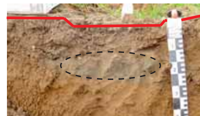
Folgeschäden unter einer mehrfach beanspruchten Fahrspur mit deutlichen Merkmalen einer Verdichtung (--- graue sauerstoffarme Zone, — Fahrspur).
