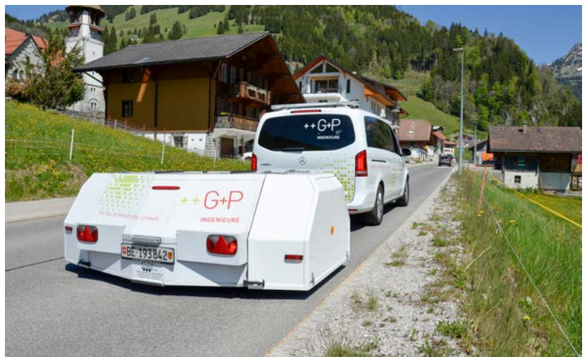
CPX-Messsystem im Einsatz. Der Anhänger ist mit Mikrofonen und weiteren Sensoren ausgestattet. Quelle: Grolimund + Partner AG
