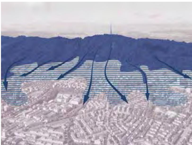
Kaltflulleitbahnen versorgen das Stadtgebiet, hier vom Uetliberg, über die Tobel, Grün- und Strassenzüge mit kühlerer Luft.
