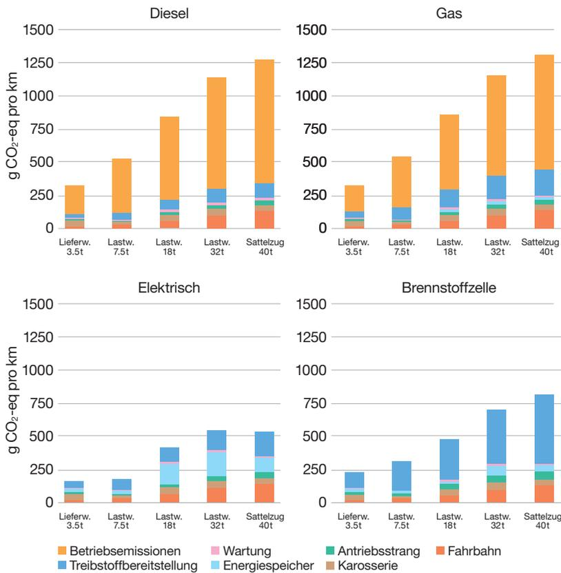
Elektrisch betriebene Fahrzeuge und Brennstoffzellenfahrzeuge haben eine deutlich bessere Treibhausgasbilanz als konventionelle Liefer- und Lastwagen.
