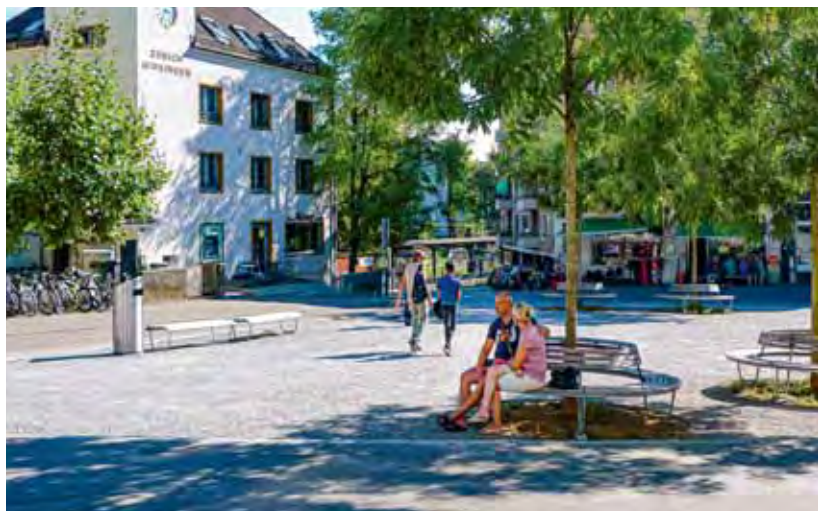
Wipkingen bekam 2014 infolge der Umgestaltung des Röschibachplatzes einen neuen, klimaökologischen Quartierplatz mit sickerfähiger Deckschicht aus hellem Kies sowie Baumpflanzungen.
