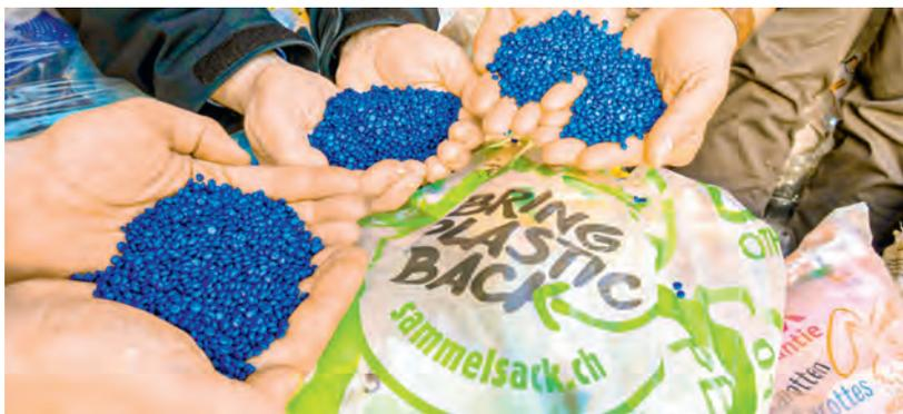
Aus dem gesammelten Kunststoff wird Granulat, als Ausgangsmaterial für neue Produkte.
