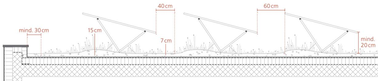
Werden Dachbegrünung und Photovoltaikanlage kombiniert, müssen Substratdicke, Pflanzenhöhe sowie Abstände gut geplant werden.
