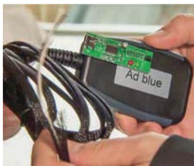
AdBlue-Manipulationsgerät. *Quelle: SRF*
