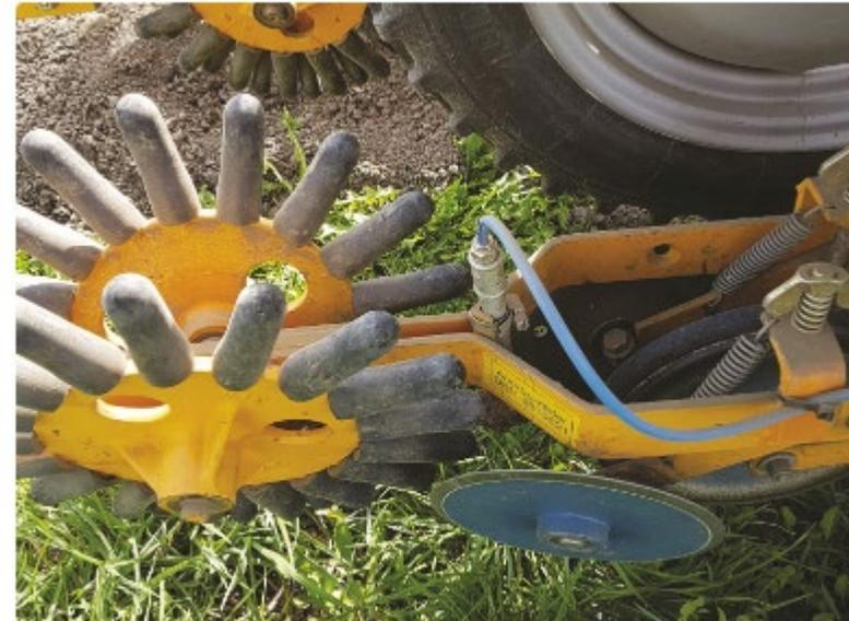
An die Sämaschine gekoppelte Bandspritzung; Quelle: SFZ
