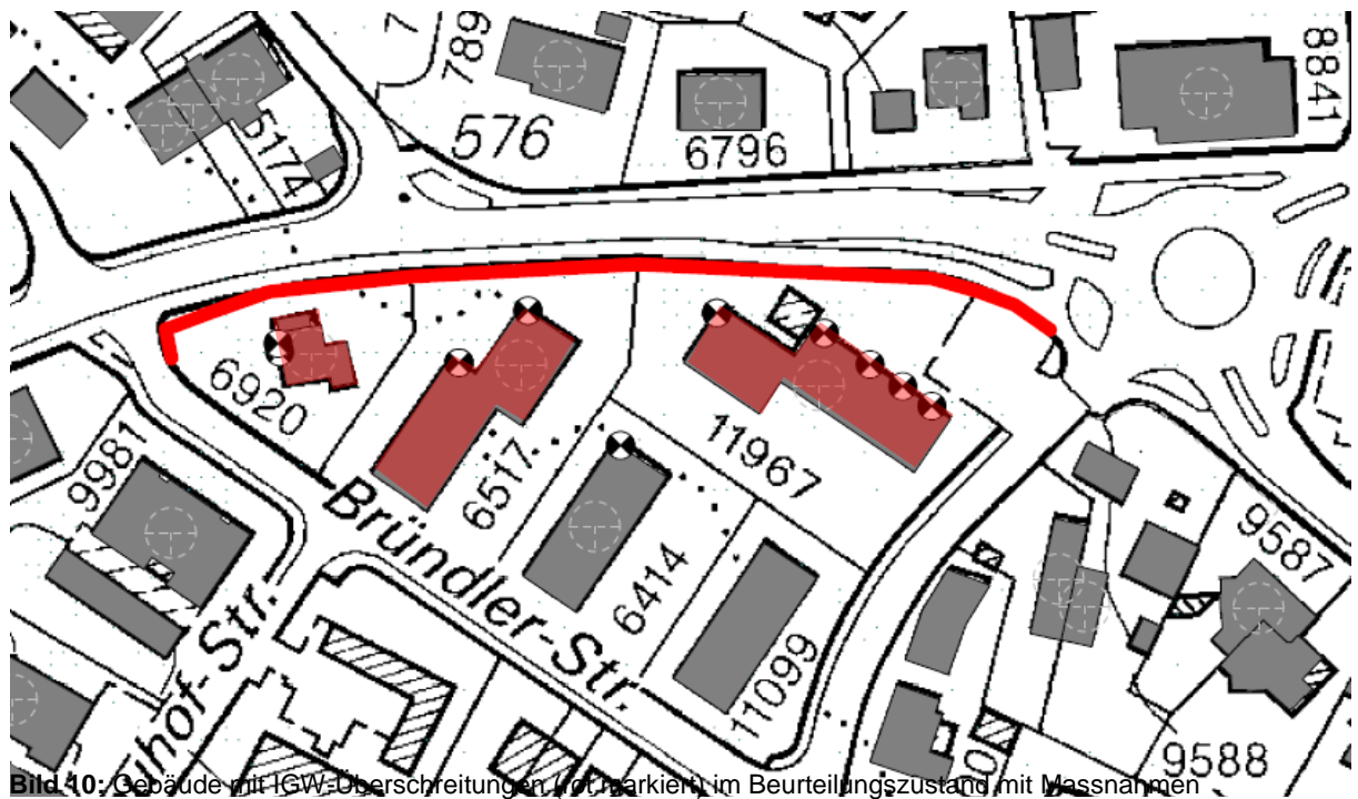
Bild 10: Gebäude mit IGW-Überschreitungen (rot markiert) im Beurteilungszustand mit Massnahmen
