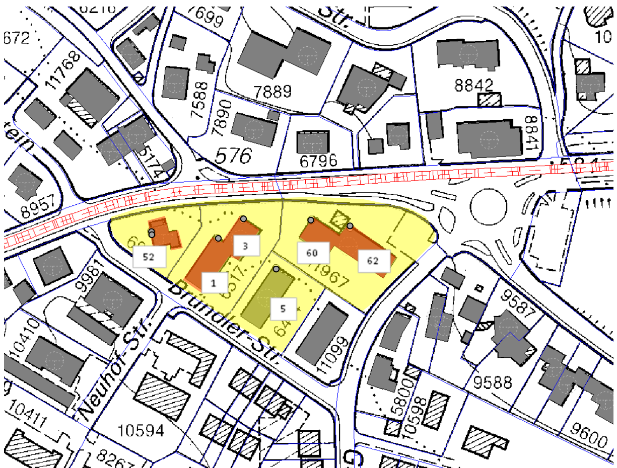
Bild 3 - Untersuchte Wohnzone (ESII) mit Immissionspunkten (runde Symbole). Rot markiert sind Gebäude mit IGW-Überschreitungen im Referenzzustand.
