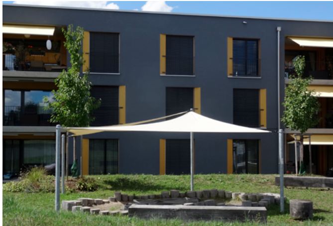
Ein beispielhafter Umgang mit Sonnenschutz: Sonnensegel beschatten den Spielbereich für Kinder, bis die Bäume gross genug sind (Genossenschaftssiedlung Silbergrueb Mönchaldorf, Bild: StadtLandschaft GmbH)
