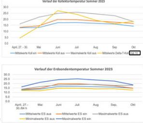
Dank grossem Durchfluss ist mittleres Delta-T über dem Kollektor mit <3K klein (steigt im Oktober, weil Pumpe nur 8 Std./d ein).
