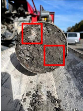
Abbildung 2: Foto eines Bohrkernes, markiert mit homogenen und heterogenen Stellen.
