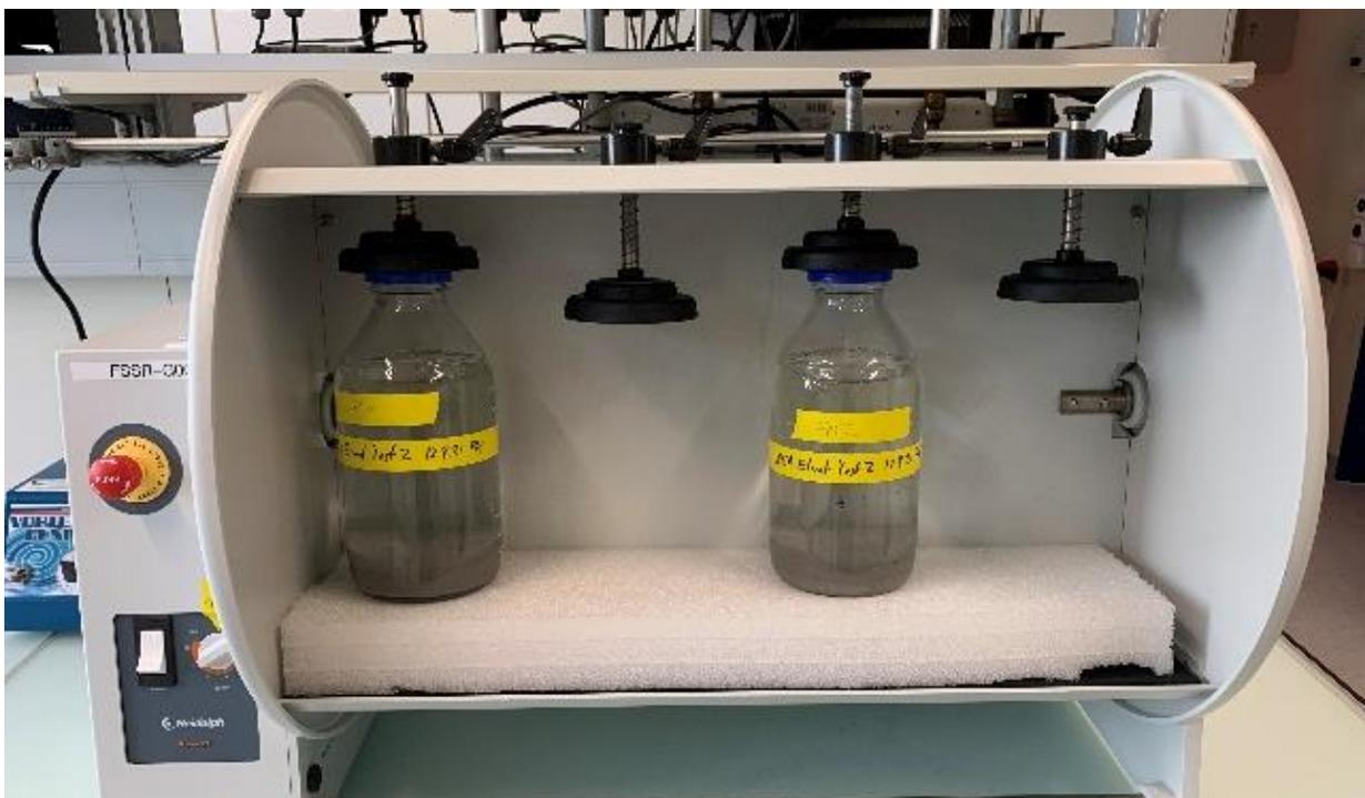
Abbildung 1: Herstellung der Eluate auf dem Überkopfschüttler bei 1 U/min.
