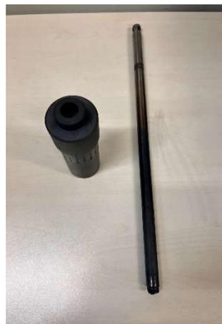
Abbildung 6: gebrochene Ventilspindel der Dampfumformstation (DUS)
