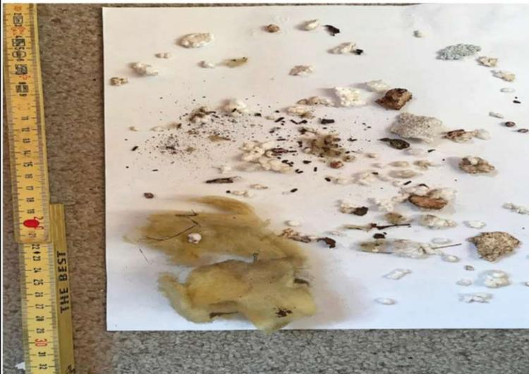
Das Styropor aus der Fassadendämmung war mit dem giftigen Flammschutzmittel HBCD belastet. Während des Rückbaus landeten diverse Kleinteile in den Nachbargärten. swica.ch
