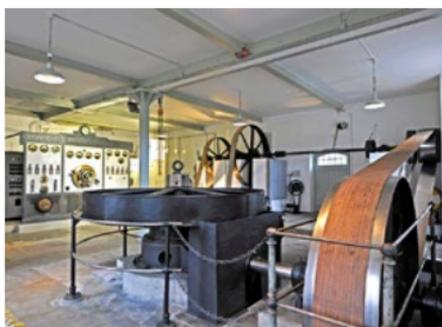
Als Kraftquelle für den Betrieb der Webstühle der mechanischen Seidenweberei Ottenbach dienen ab 1910 Dynamo und Generatoren im Inselbetrieb. Falls im Winter zu wenig Wasser verfügbar war, kam eine Dampfmaschine zum Einsatz. Zur Sicherstellung eines Dauerbetriebs erfolgte 1937 die Vernetzung mit dem Ortsnetz. Grafiken und Bilder veranschaulichen diese Entwicklungsschritte. Als Höhepunkt wird bei der Inbetriebsetzung der Turbinenanlage die Synchronisierung mit dem Stromnetz demonstriert.
