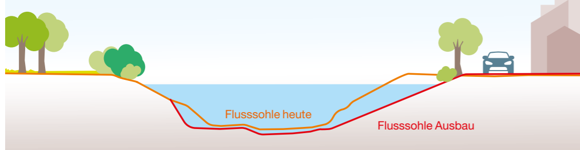
Querprofil mit Verbreiterung Flusssohle
