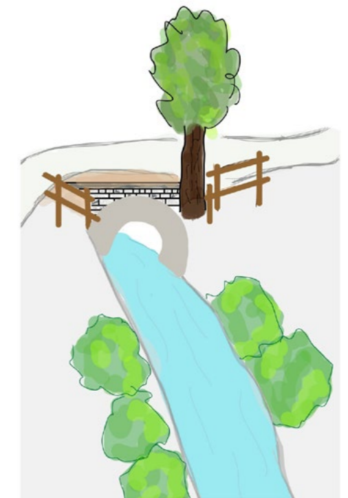
Eindolungen sind oberirdische Fliessgewässer, die in Leitungen verlegt worden sind.
