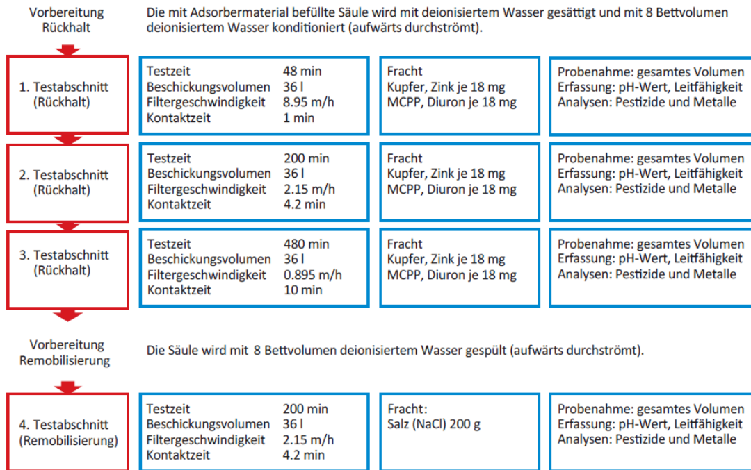
Abbildung 8: Schrittweises Vorgehen zur Bestimmung des Stoffrückhalts und der Remobilisierung im VSA-Säulenversuch (VSA, 2023).
