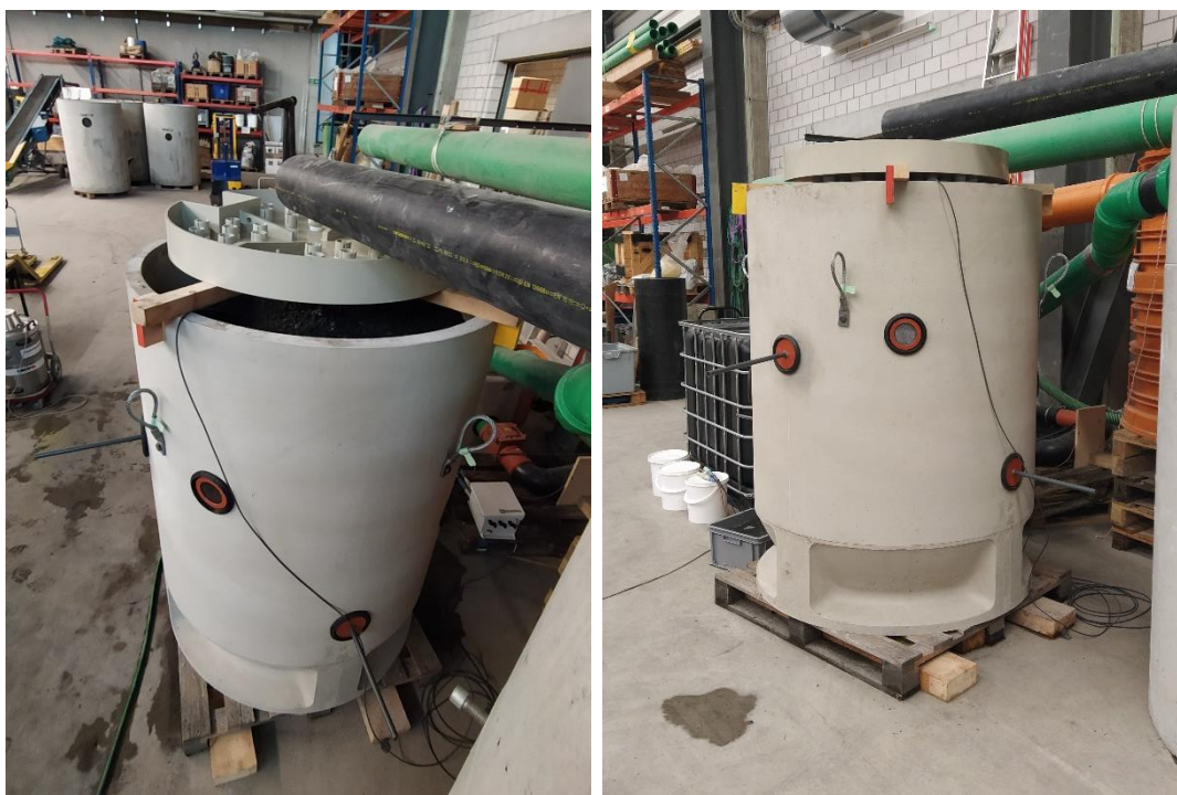
Abbildung 27: Aufbau der Schachtrigole mit den drei Baumsubstraten.
