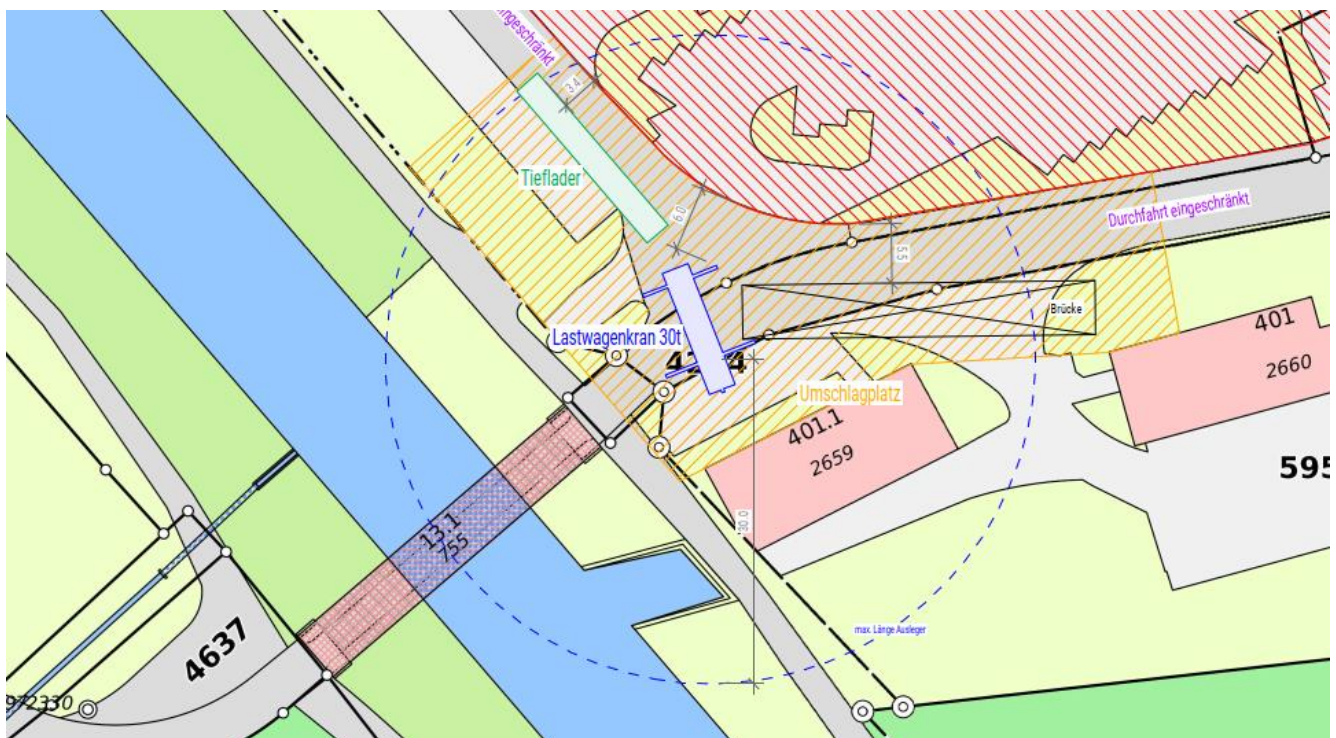
Abbildung 16: Zerlegen der Brücke
