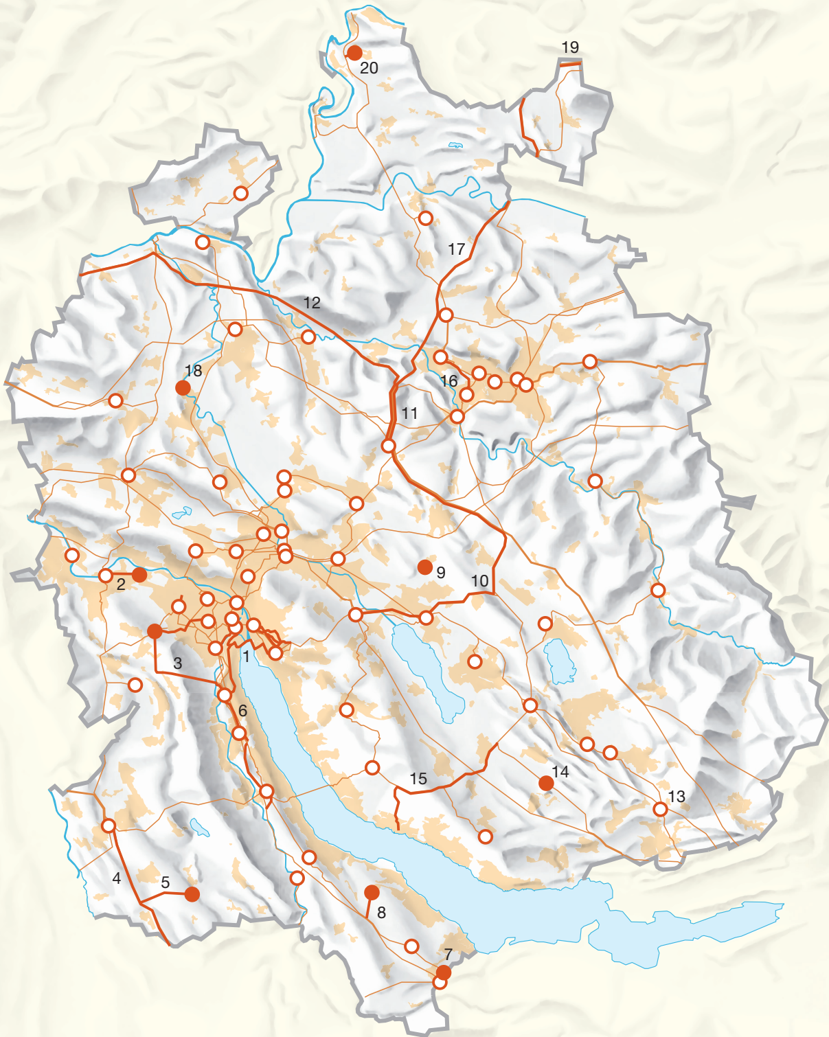
Abb. 5.3 Unterwerke sowie Hoch- und Höchstspannungsleitungen 1:300 000
