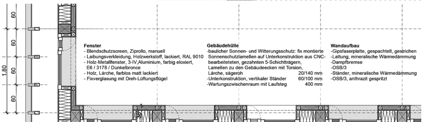
Konstruktionsschnitt, Konstruktionsgrundriss und Teilansicht 1:50
