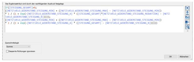
Abbildung 4: Formel für den Widerstandsfaktor Steigung
