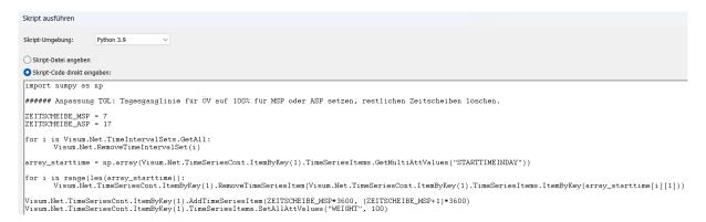
Abbildung 78: Ausschnitt des Skripts für Umstellung Spitzenstundenmodell
