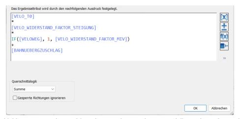
Abbildung 3: Widerstandsberechnung Velo im Umlegungsmodell: Streckenwiderstand
