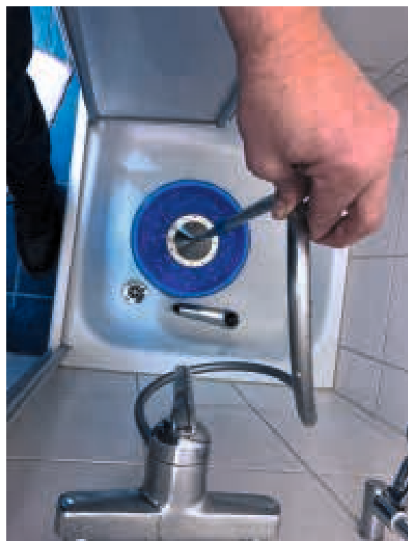
Abb. 8.4.2: Mehr Probenvolumen durch Filterbeprobung vor Ort. Anstelle der Duschbrause wurde ein Membranfiltergehäuse aufgeschraubt. Das Volumen des filtrierte Wassers wird mit einem Messeimer bestimmt
