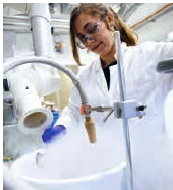
Abb. 6.2.1: Granatäpfel werden vor dem Vermahlen mit Flüssigstickstoff gefroren (Cryomilling)
