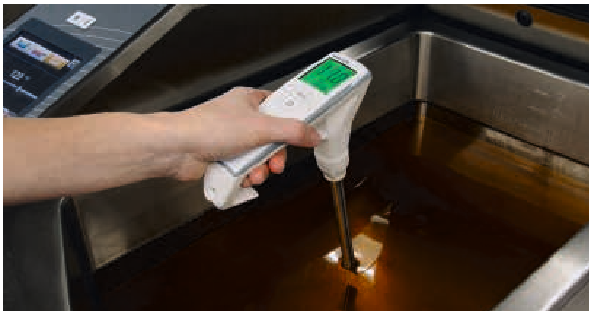
Abb. 5.2.2: Schnelltest mit einem Handmessgerät zur Messung des polaren Anteils in Frittieröl
