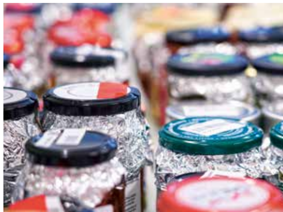
Abb. 5.3.1: Konservengläser im Labor: Die Alufolie zwischen Deckel und Lebensmittel stoppt die weitere Migration ab dem Zeitpunkt der ersten Analyse.
