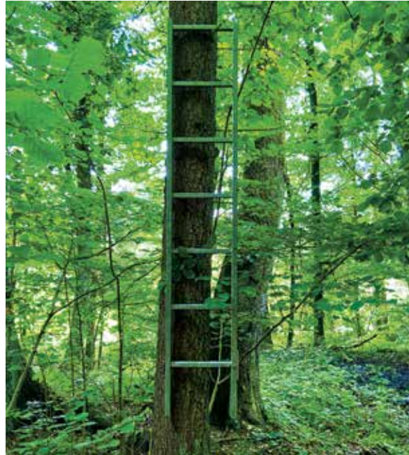
Abb. 8.1.2: Nicht sachgerecht gelagerte Leiter für den direkten Kontakt mit Trinkwasser.
