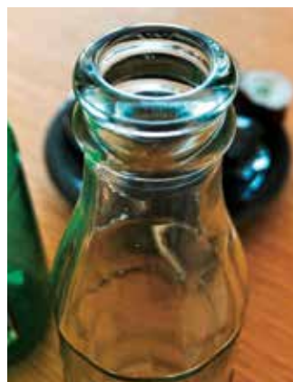
Abb. 7.1.1: Glasflasche mit Glasbruchstellen: «Wire edge» (herausgebrochene Glasfasern aus der Flaschen-Mündung); die Glassplitter wurden als Fremdkörper im Getränk festgestellt.
