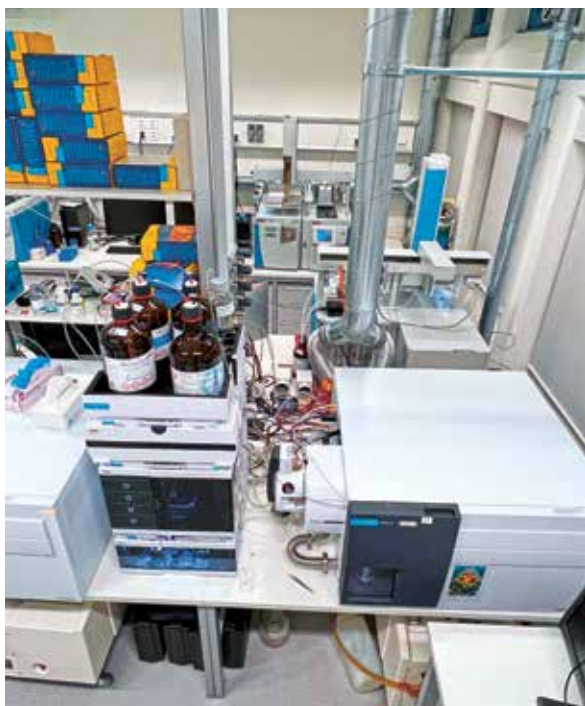
Abb. 6.2.6: Blick ins Messlabor mit Massenspektrometern, ohne die Rückstandsuntersuchungen auf Pestizide gar nicht möglich wären.
