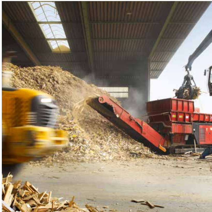
Eine der vier Altholzschredderanlagen im Kanton Zürich.
