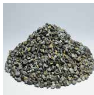
Wertvolle NE-Nichteisen-Metalle (5–8 mm) direkt aus dem Separationsprozess.
