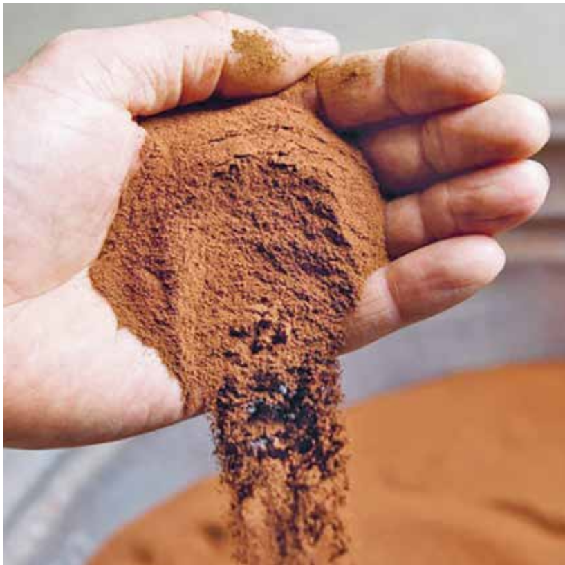
Phosphorhaltige Klärschlamm-Asche nach Verbrennung des zentral verwerteten Klärschlammes; sie ist die Basis für die Phosphorrückgewinnung im Phosphor Mining.
