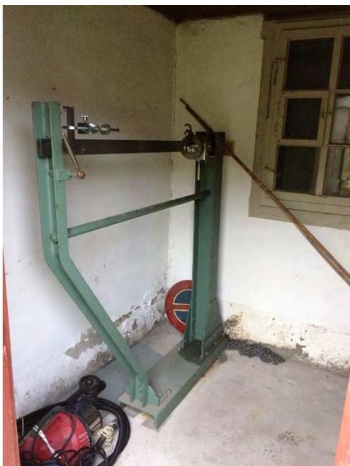
Brückenwaage, Innenaufnahme Laufgewichtsbalken, 15.11.2016 (Bild Nr. D101076\_56)
